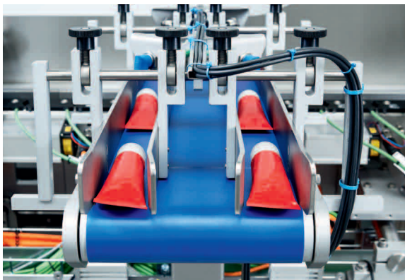
Für Nachschub ist immer gesorgt: Servogesteuerte Eintaktförderer transportieren immer zwei Tuben parallel zur Ladestation der Carrier.
