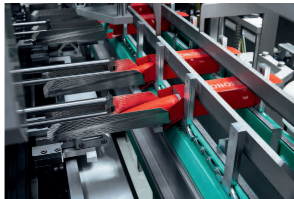
Die kritische Passage: In diesem Abschnitt laufen MCS und Kartonierer synchron; im hinteren Bereich erfolgt der Einschub in die Faltschachtel.
