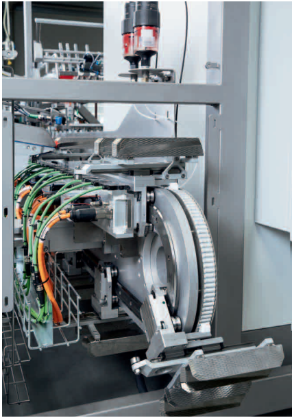
Platzsparend und effizient: Der Rücklauf der Carrier erfolgt kosteneffizient durch einen servogeregelten Zahnriemenantrieb.
