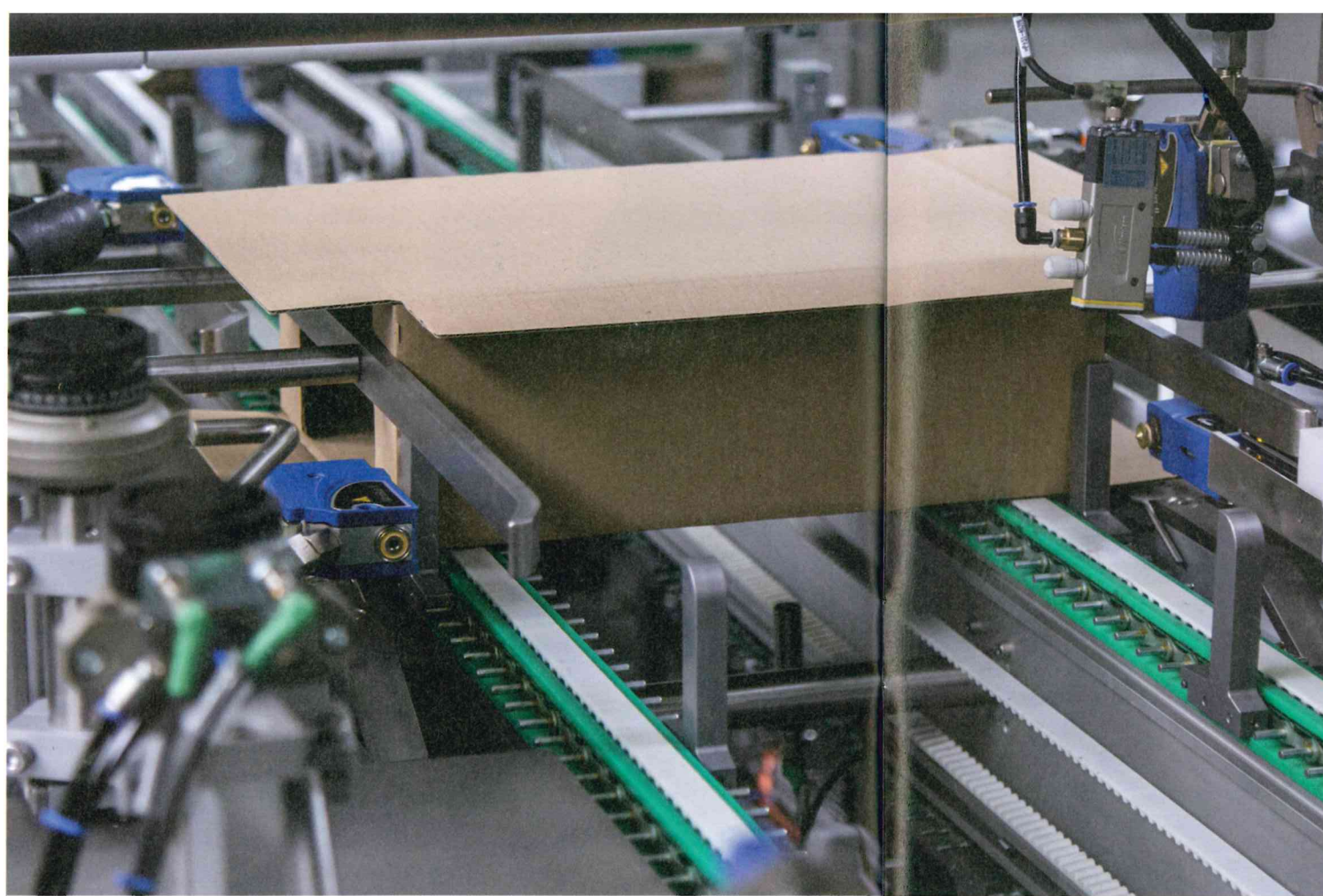
Die Verklebung der Umkartons geschieht mithilfe von fünf pneumatischen Applikatoren des Typs MiniBlue II Slim Line
