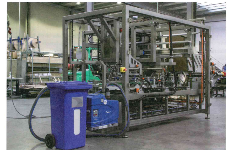
Kompakter Sammelpacker SP-I-24-R(L) + PZ von Econo-Pak mit einem Hotmelt-Auftragssystem ProBlue Liberty 14 von Nordson
