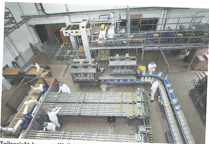
Teilansicht der neuen Waffeltüten-Anlage. Zu erkennen sind die Produktzuführung aus dem Froster (links oben), das Pick- und Kartoniersystem mit drei der insgesamt vier Roboter, die zwei Kartonaufrichter und dahinter die Endverpackungs-Sektion
